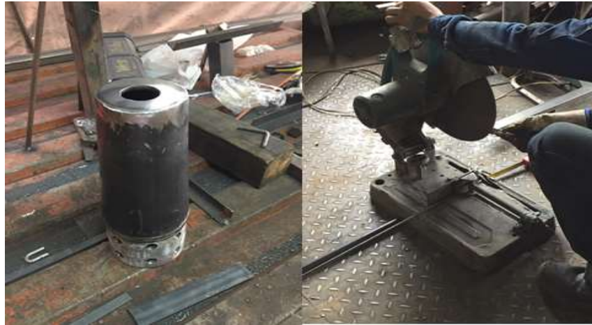
Figura 13. Soldado, mecanizado, torneado y perforado de las piezas.
