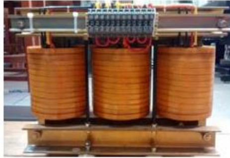
Figura 8. Transformador trifásico tipo seco- analizado en artículo
