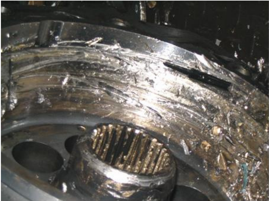
Figura 137. Superficies internas rayadas en Bomba PVV540
