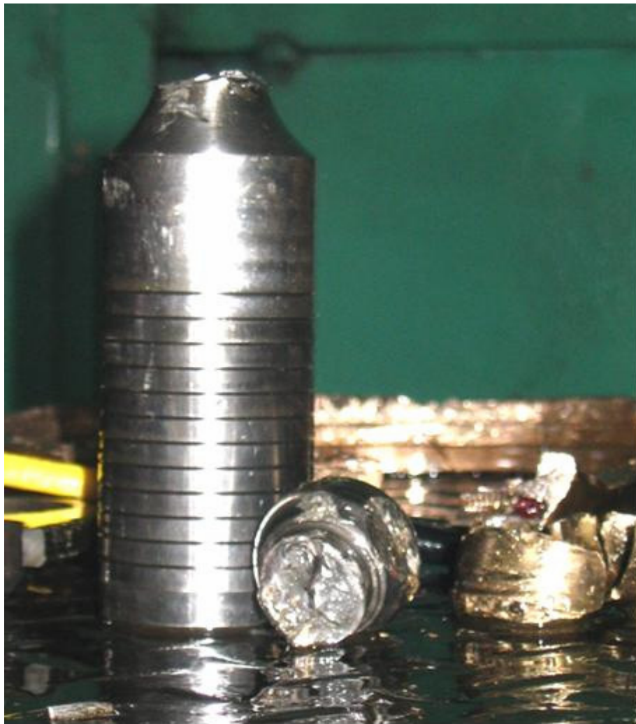
Figura 146. Pistón y Cojinete Patín de Deslizamiento gravemente deteriorados
