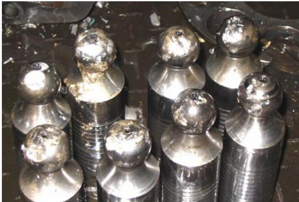
Figura 138. Pistones deteriorados superficialmente en bomba PVV540
