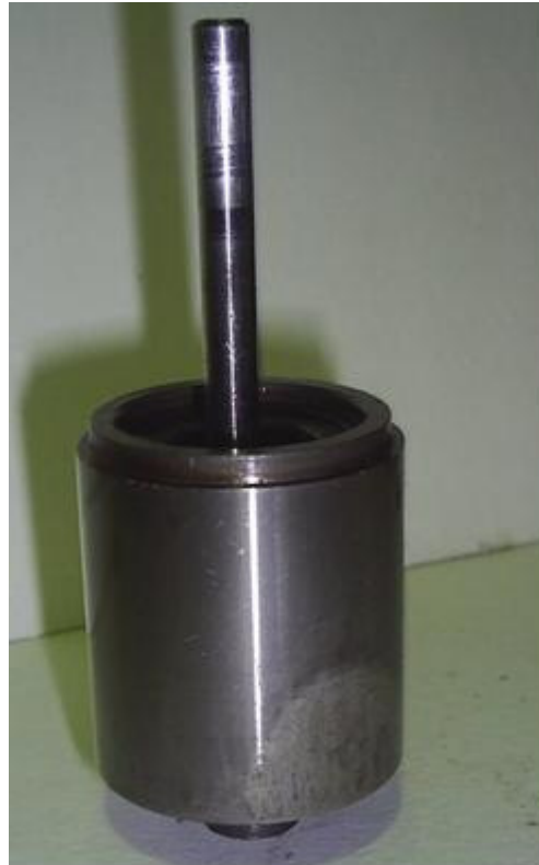
Figura 103. Desgaste de Alojamiento de Resorte
