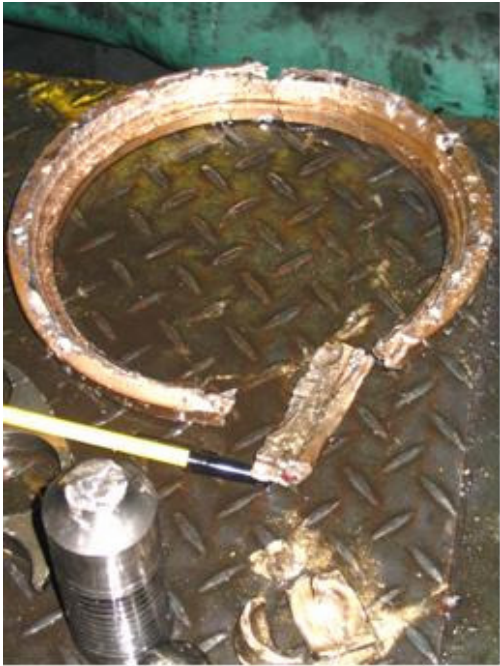
Figura 139. Aros, Anillo Retenedor, Patín cojinete y Pistón deteriorados en Bomba PVV540
