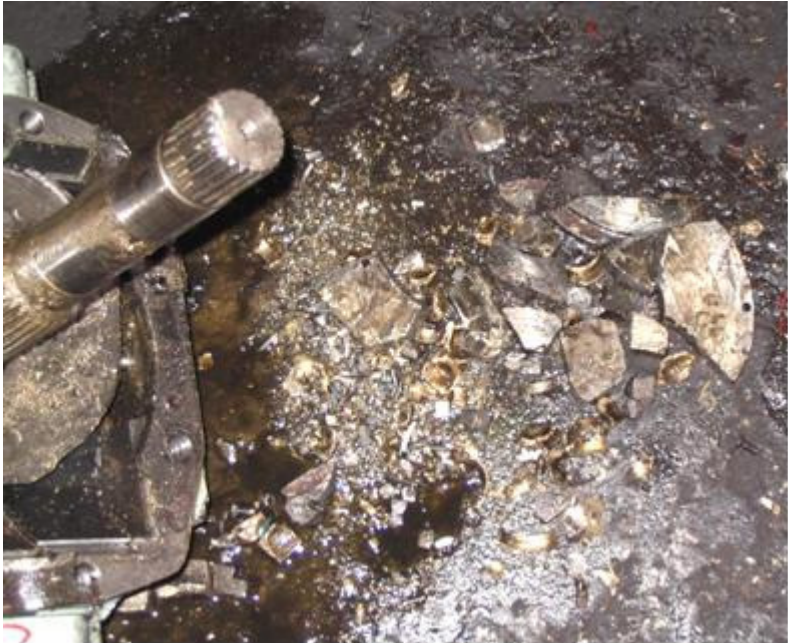
Figura 136. Componentes internos destruidos de Bomba PVV540
