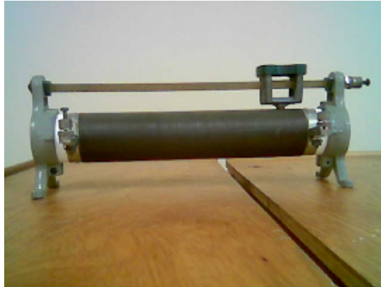
Figura 34 Resistencia de Potencia empleada como carga
