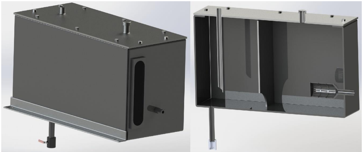
Figura 22. Diseño del tanque hidráulico.
