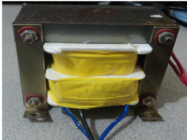
Figura 7. Transformador de potencia.
