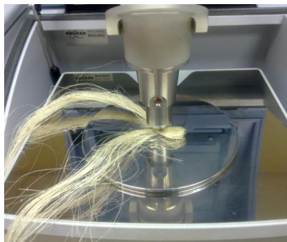
Foto 7. a) Espectrómetro infrarrojo Bruker; b) IR de las muestras
