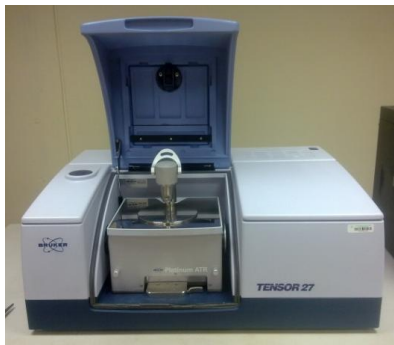
Foto 7. a) Espectrómetro infrarrojo Bruker; b) IR de las muestras
