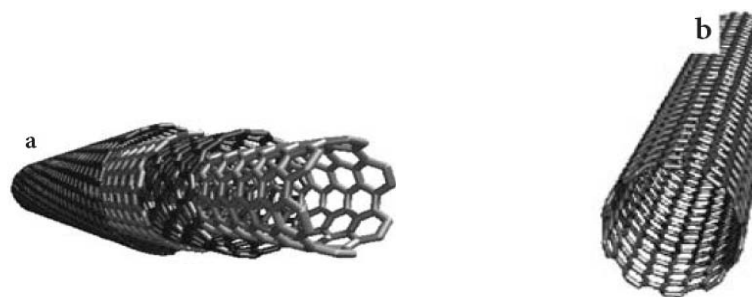
Figura 6. NTC según el número de capas: a) NTC de capa múltiple, b) NTC de capa única (Zhao y col., 2009).
