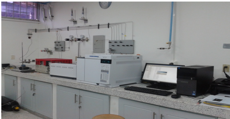
Figura 4. Instalación realizada al cromatógrafo Agilent 7890A.
