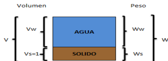
Figura 21: Relaciones peso- volumen (Suelo saturado).
