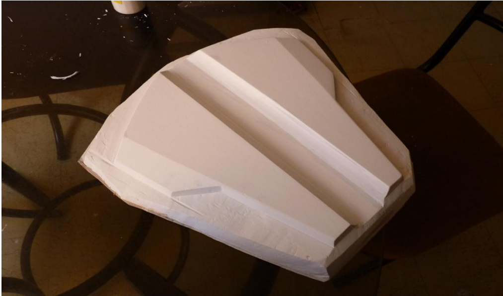
Gráfico 4. Molde en Yeso para termoformado
