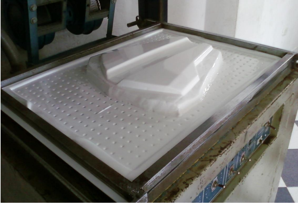
Gráfico 6. Termoformado por vacío
