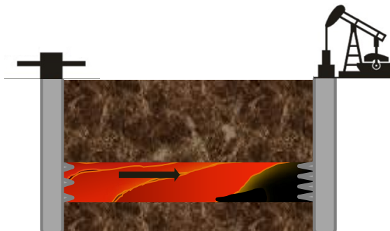
FIGURA 6. Frente de combustión a diferentes tiempos en una arena de espesor delgado.
