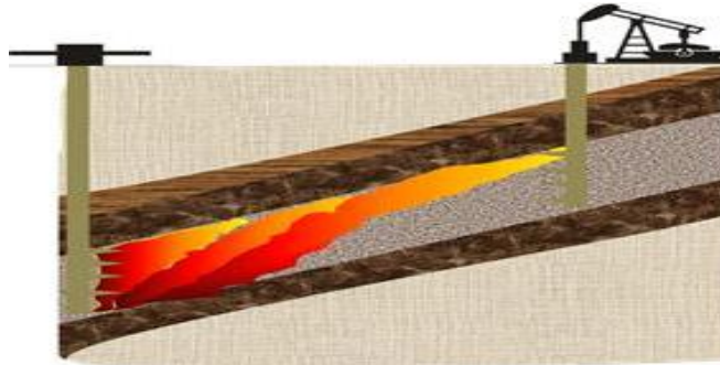
FIGURA 8. Overburn por inyección buzamiento abajo
