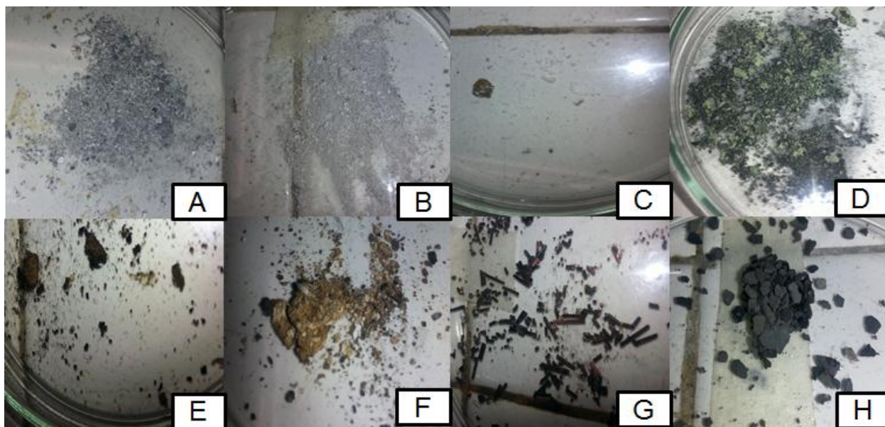
Figura 20. Residuo terminada la depolimerización del PMMA troceado: \text{TiO}_2 (A), \text{ZnO} (B), \text{B}_2\text{O}_3 (C), \text{NiO} (D), polvo de vidrio (E), \text{CaO} (F), \text{CuO} (G) y clinoptilolita (H).
