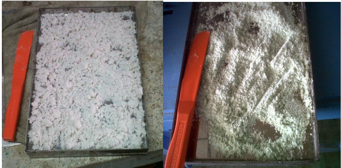
Figura 11. Polimetilmetacrilato postconsumo. De izquierda a derecha: polímero antes de secar en la estufa y polímero luego de secado.
