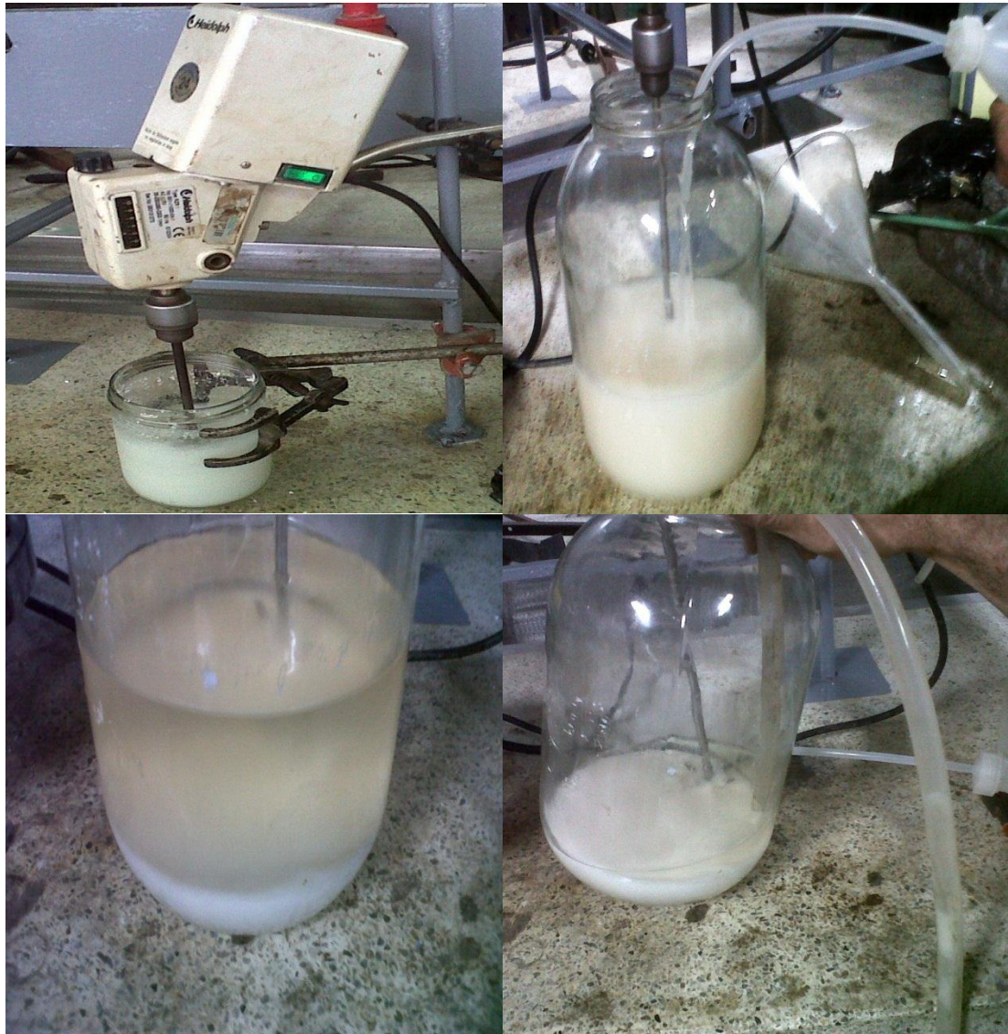
Figura 9. Agitación, lavado con metanol, decantación y extracción del Polimetilmetacrilato.
