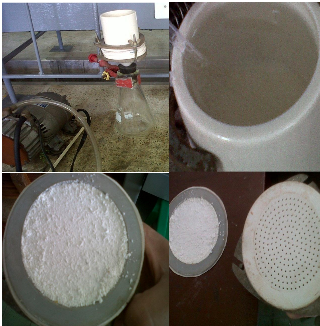
Figura 10. Lavado con metanol en un embudo de doble capa por filtración al vacío.
