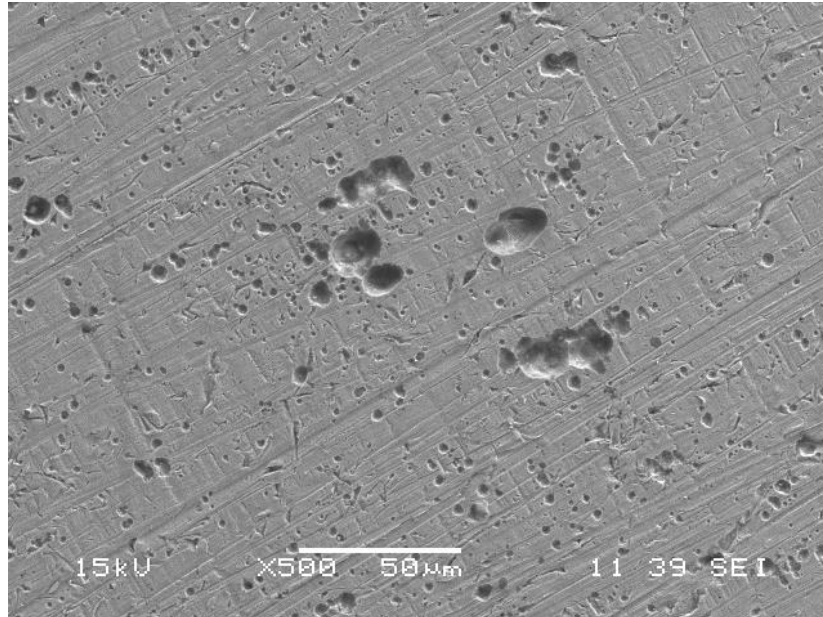
Figura 28. Micrografía SEM-EDS para la muestra de 10 días con acabado superficial 1500 y la temperatura 60 °C.
