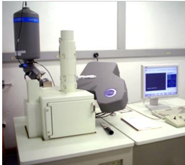
Figura 9. Equipo de microscopía electrónica de barrido (SEM) JEOL JSM5910 LV, universidad Nacional de Colombia sede Medellín.
