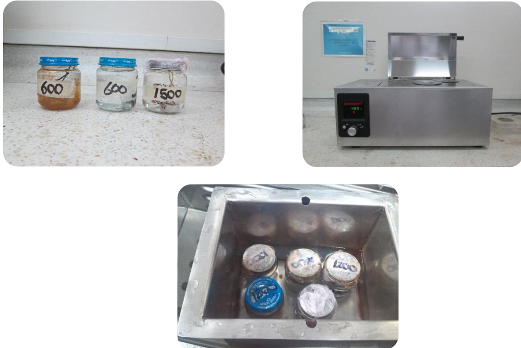
Figura 6. Montaje de las probetas sometidas al ensayo de inmersión en la solución electrolítica.
