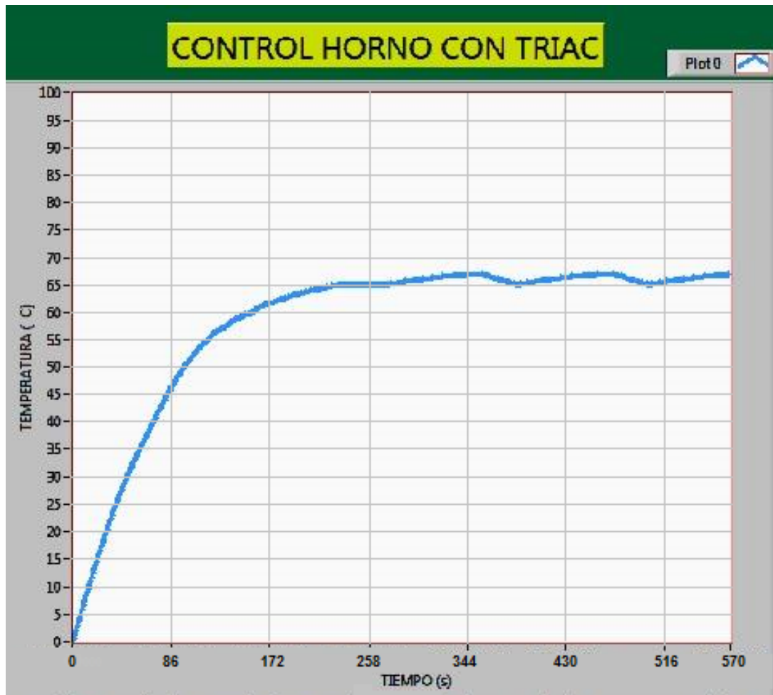
Figura 38. Respuesta del horno para K_p=2 y T_i=335 empleando LabVIEW
