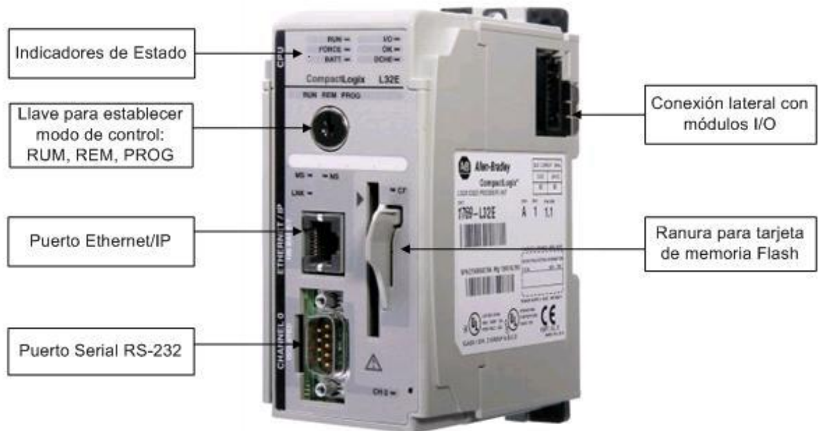
Figura 5. Características principales del controlador CompactLogix 1769-L32E
