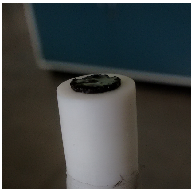
Figura 6. Vista lateral del depósito obtenido sobre un electrodo de disco de titanio a partir de una solución acuosa con 50 mM CdSO_4 , 10 mM SeO_2 , 1 mM HgCl_2 en 100 mM de Na_2SO_4 \cdot 10H_2O , a 40^\circ C y pH 2,3. El potencial de deposición fue mantenido durante 75 min en -0,7 V vs Ag|AgCl|3M KCl.
