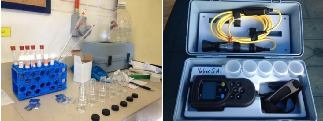
FIGURA 49 EQUIPOS PORTABLES DE ANÁLISIS DE CALIDAD DE AGUA.
