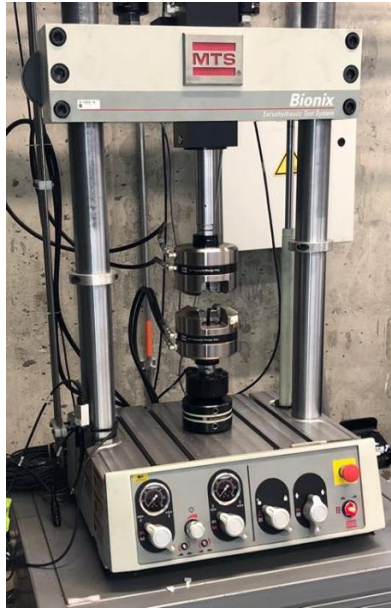
Figura 3. Máquina MTS Bionix usada para los ensayos a tracción.
