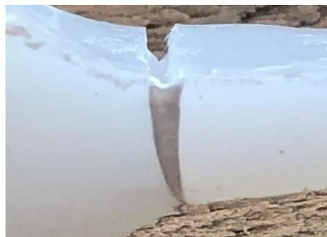
Figura 8. Detalle de la rotura conseguida en la probeta.
