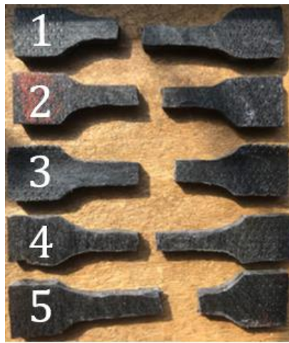
Figura 7. Probetas sometidas a carga estática material Nylon 66.
