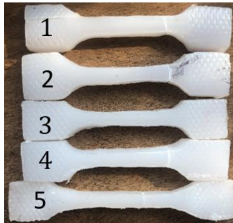
Figura 6. Probetas sometidas a carga estática material UHMW.
