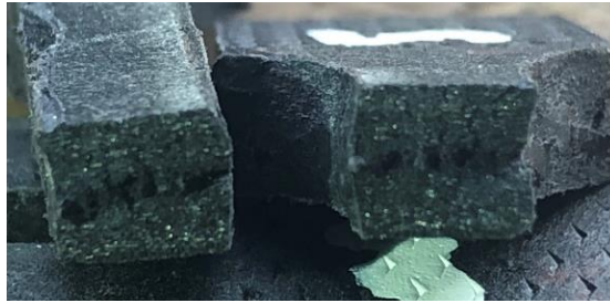
Figura 9. Detalle de la rotura conseguida en la probeta.
