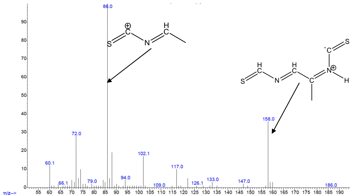
Figura 28. Espectro de masas del derivado del propineb. Columna DB-5 de 30m x 0,25mm x 0,25 \mu m, splitless pulsado, modo full scan (40 - 300 m/z )
