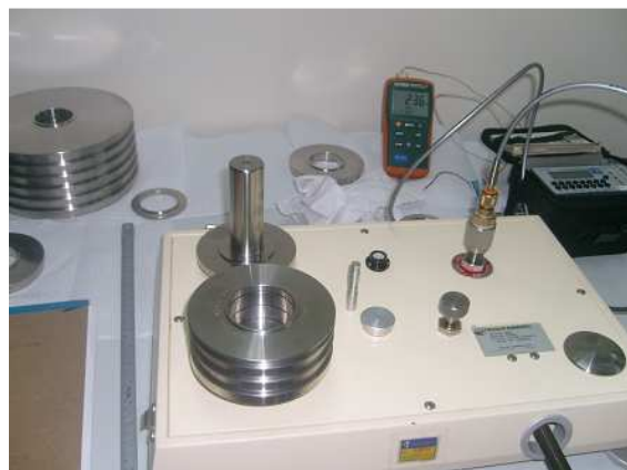
Figura 5. Montaje procedimiento de calibración medidor de presión manométrica.
