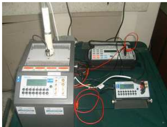
Figura 7. Montaje para la calibración de la RTD.
