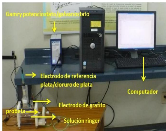
Figura 18. Montaje utilizado para los ensayos de corrosión.
