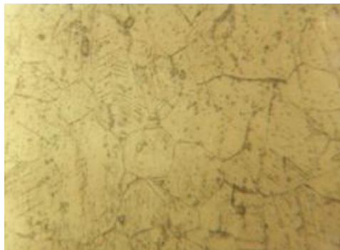
Figura 10. Metalografía del acero 316LVM revelada con ácido oxálico.400x
