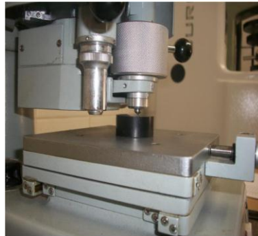
Figura 19. Microdurometro Shimadzu Tipo M, indentador cono de diamante.
