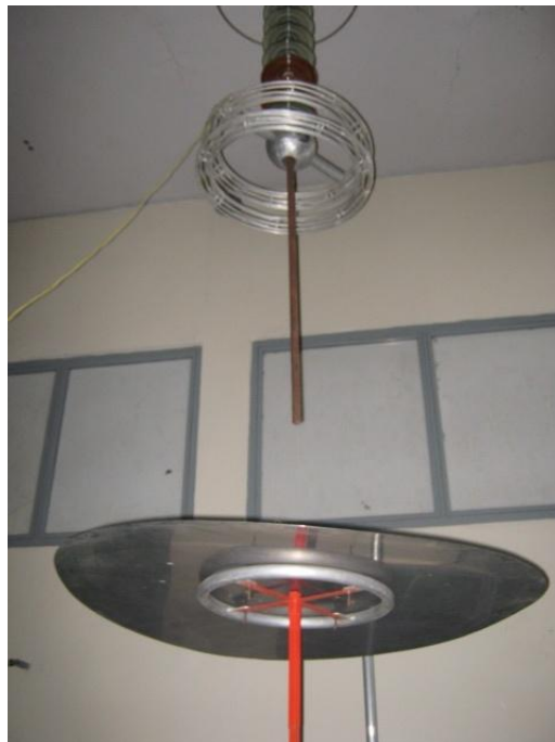
Figura 25. Configuración electroda punta-placa.
