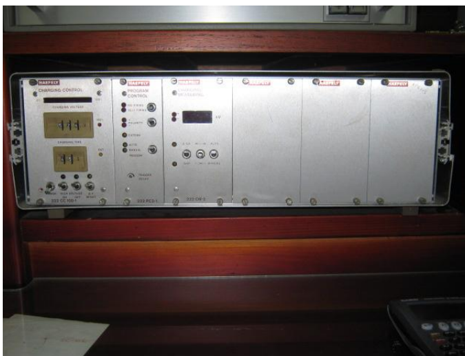
Figura 19. Consola de mando tipo GC 222.
