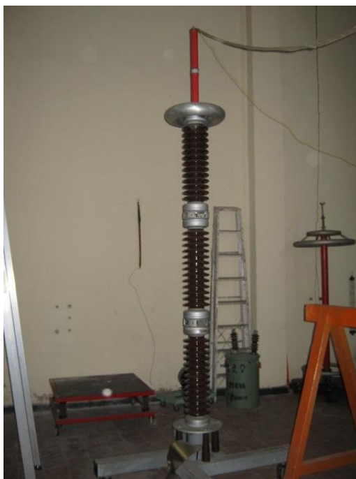
Figura 23. Divisor capacitivo marca Haefely.
