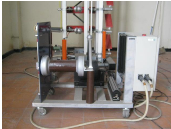
Figura 20. Unidad de carga tipo LGR 100/15.
