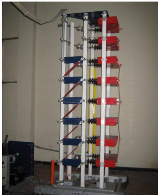
Figura 21. Generador de impulsos tipo SGS 800/20.
