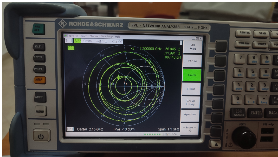
Figura 69: Impedancia de la antena con el stub 1
