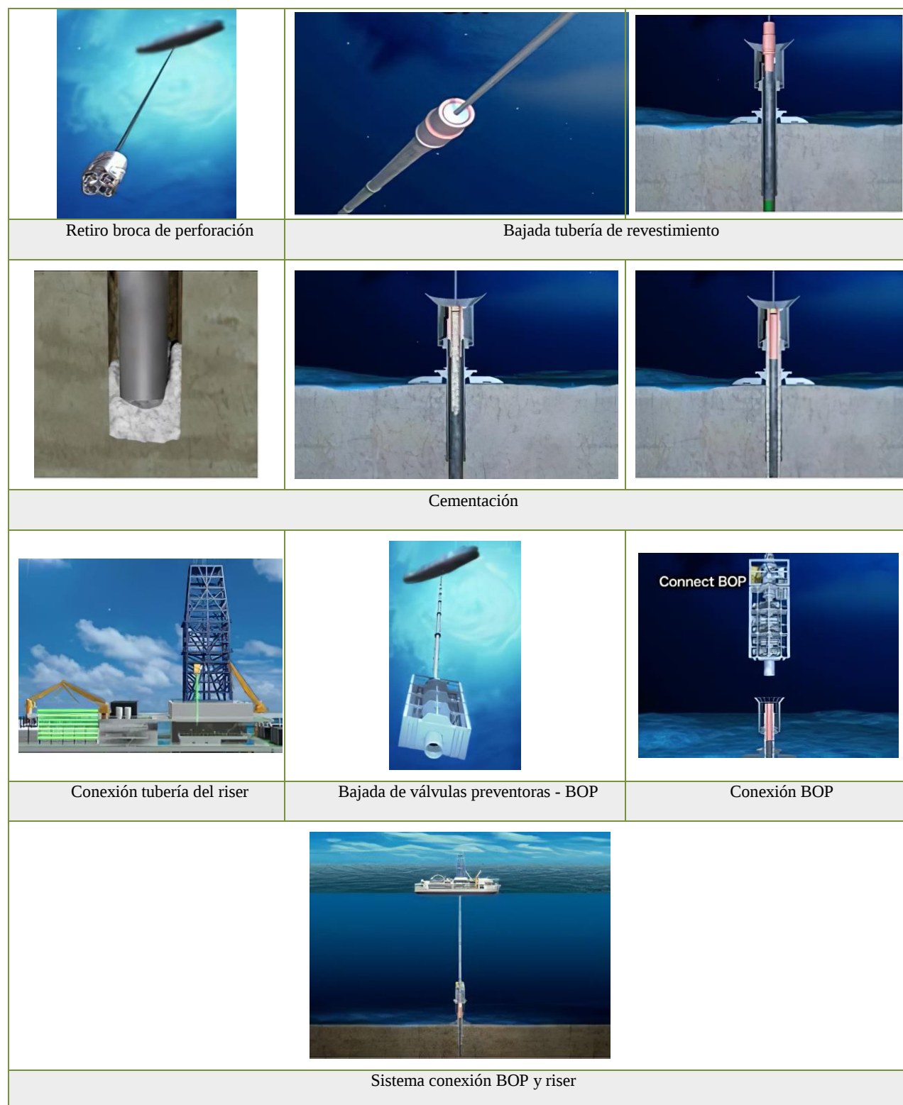
Figura 59. Etapas de Perforación.
