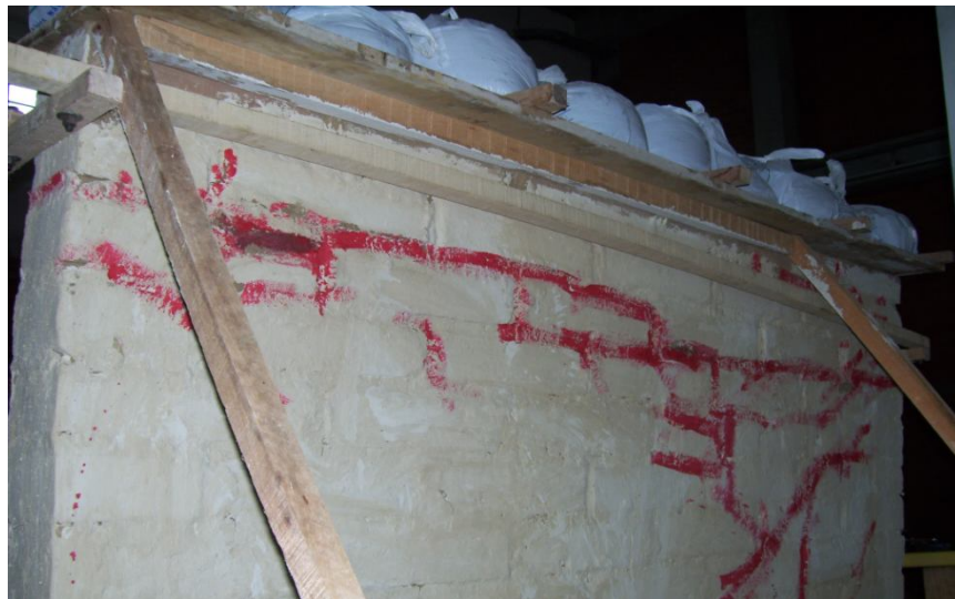
Figura 37. Falla agrietamiento muro sin confinamiento
