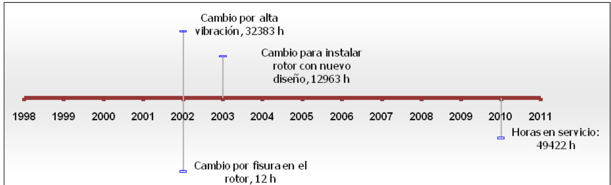
Figura 32. Línea de tiempo para el compresor centrífugo. Unidad HP3.
