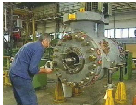
Figura 16. Vista general de la carcasa y tapa frontal del compresor 10
