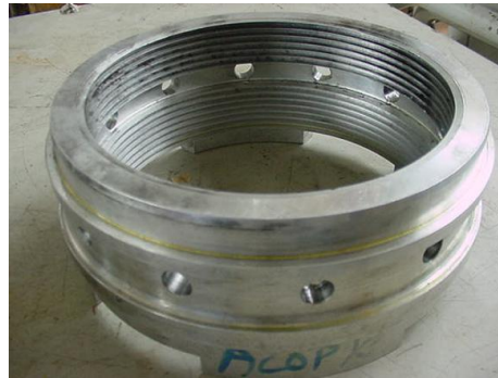
Figura 20. Sello laberinto desmontado de unidad Compresora
