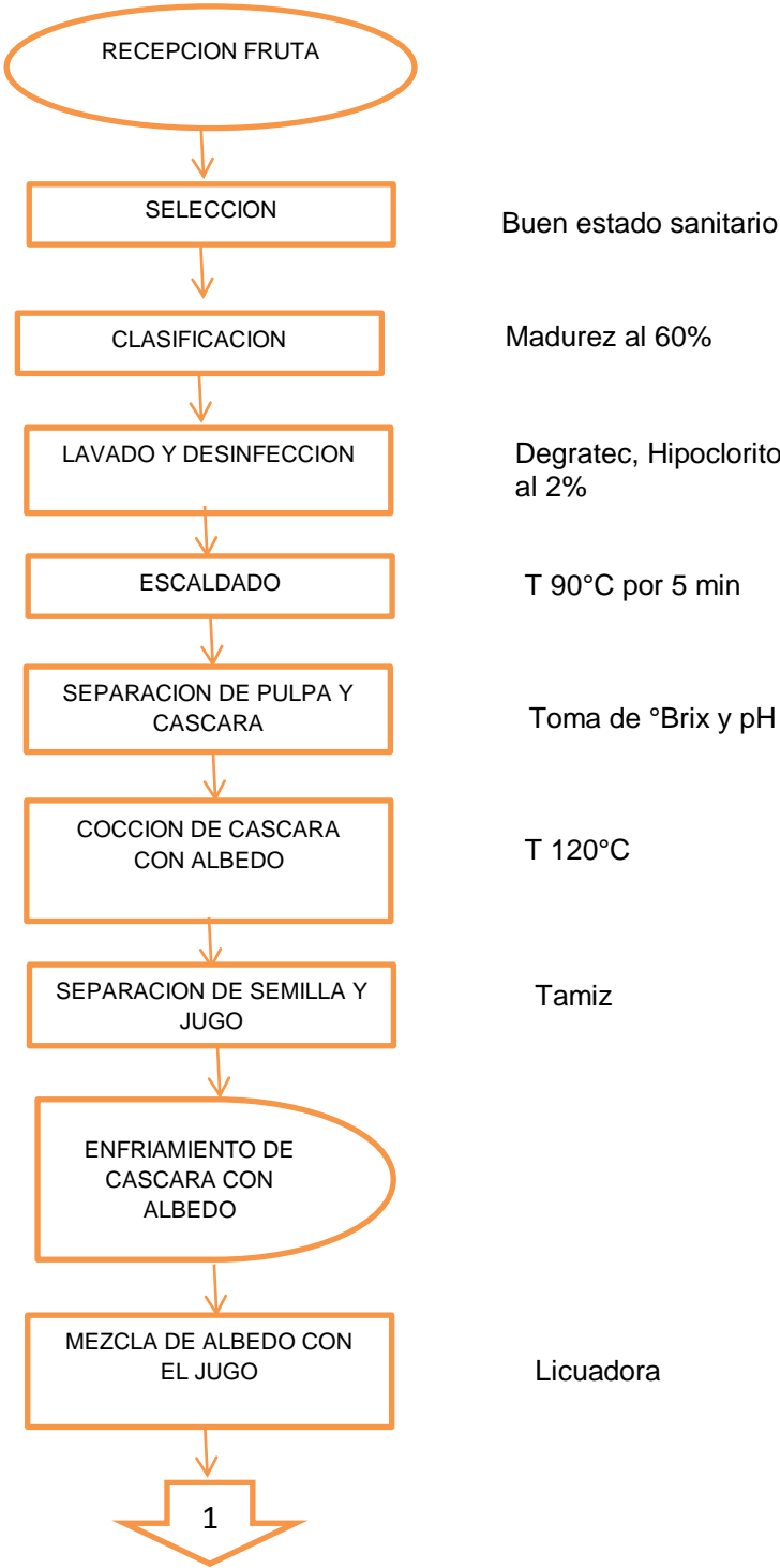
Imagen 4. Diagrama de Flujo de la preparación del Bocadillo
