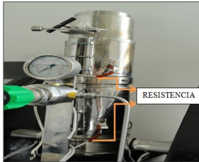
Figura 19. Calefacción, resistencias eléctricas del BULK 350 – BULK VOLUME CELL.
