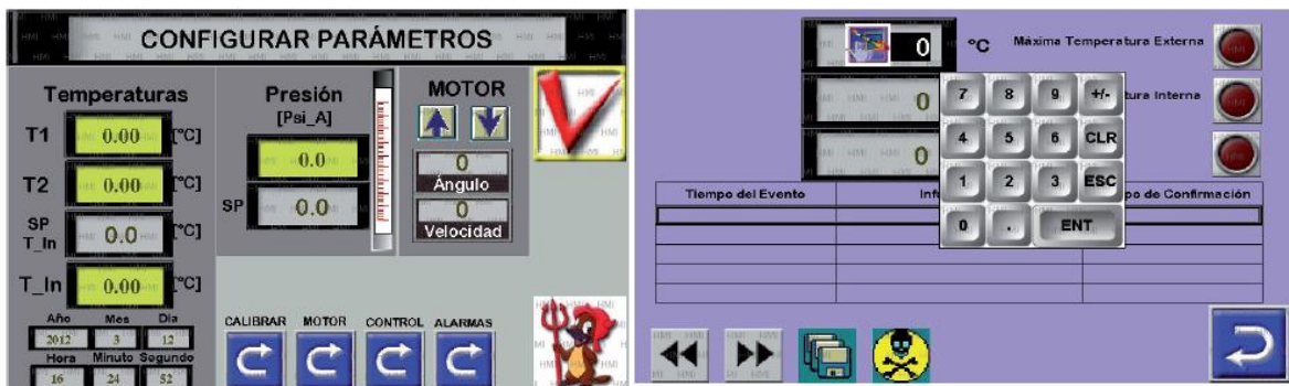
Figura 32. (A) Configuración (B) máxima temperatura externa. Estableciendo alarmas y valores máximos. Fuente: Autores.
