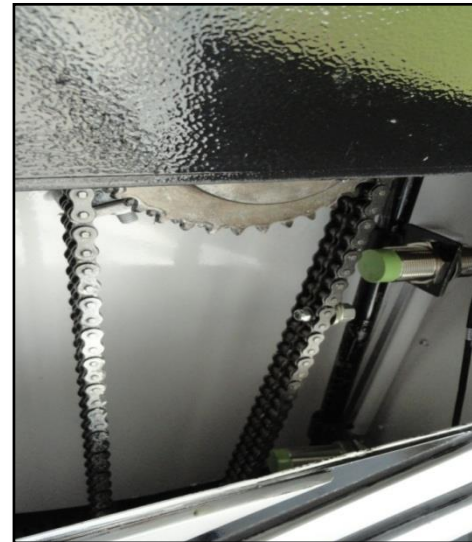
Figura 20. (A) Motor unido a la cadena de transmisión (B) Cadena y piñón de rotación. Fuente: Autores.
