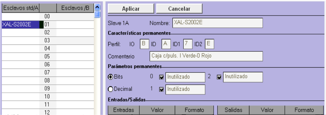
Figura 25: BOTONERA XAL-S200E BIEN CONFIGURADA
