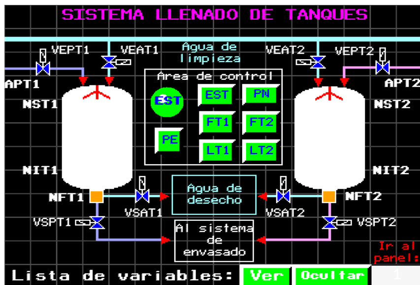
Figura 6 (panel 2): sistema llenado de tanques real.
