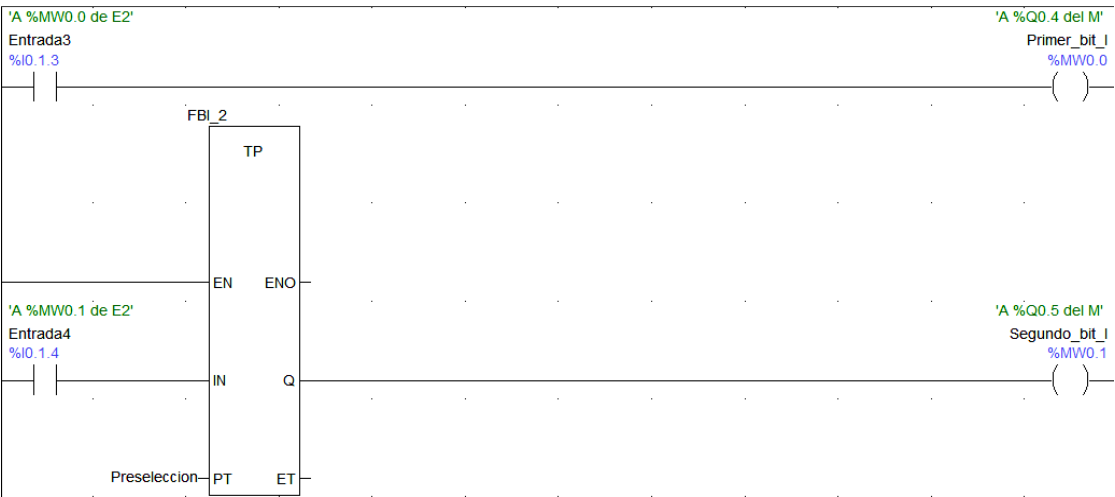
FIGURA 44: LECTURA DE LOS BITS 0 Y 1 DE LA PALABRA %MW0
