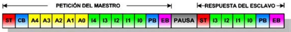
Figura 13: Estructura de los mensajes AS-i
