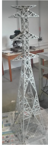
Figura 20. Torre a escala 1:30 unida a malla resoldada
