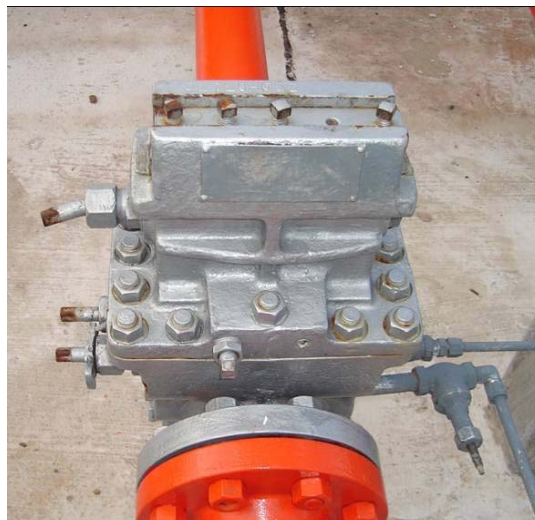
Figura 41. Medidor de Tipo Diferencial Para Cuantificar el Gas Producido
