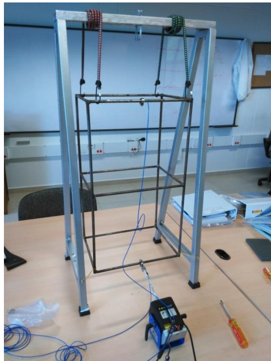
Figura 18. Estructura soporte con bandas elásticas
