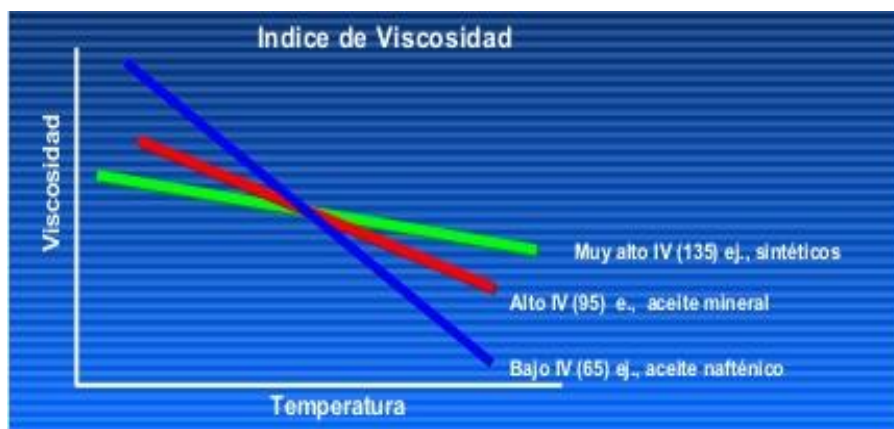
Figura 8. Variación de la viscosidad con el aumento de temperatura en tres lubricantes de diferentes índices de viscosidad.
