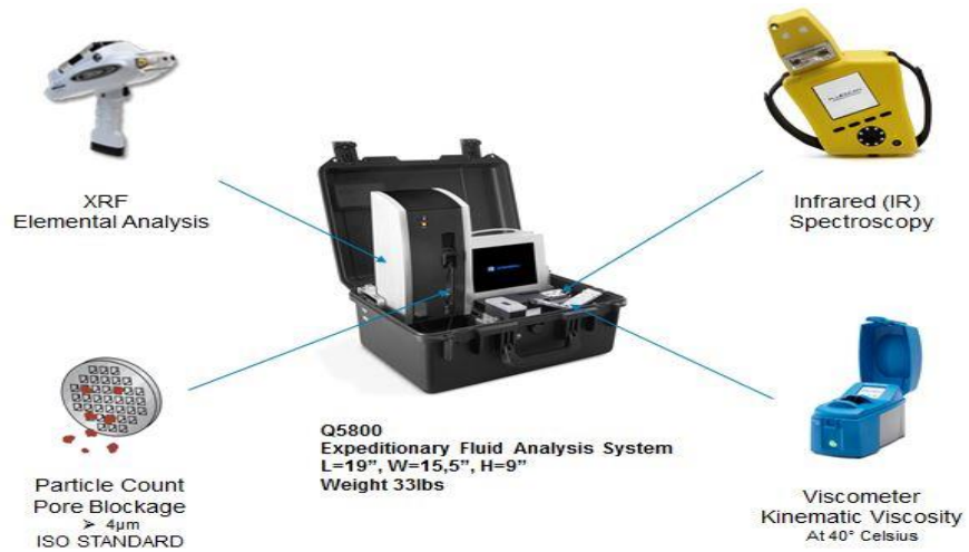
Figura 38. Laboratorio portátil para analizar el estado y desempeño de los lubricantes.
