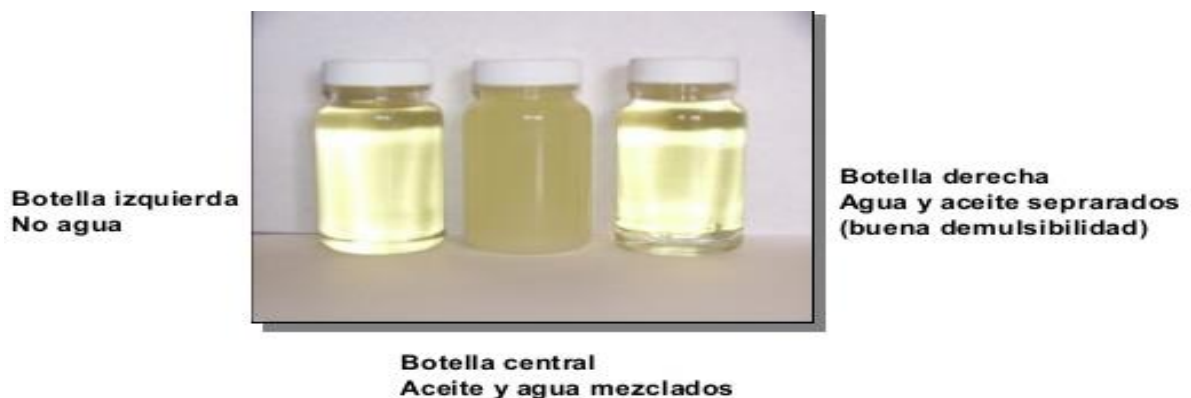
Figura 9. Diferentes muestras de aceite lubricante que muestran la habilidad de separar agua.
