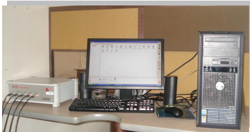
Figura 12. Potenciostato galvanostato de ACM Instruments Gill AC.
