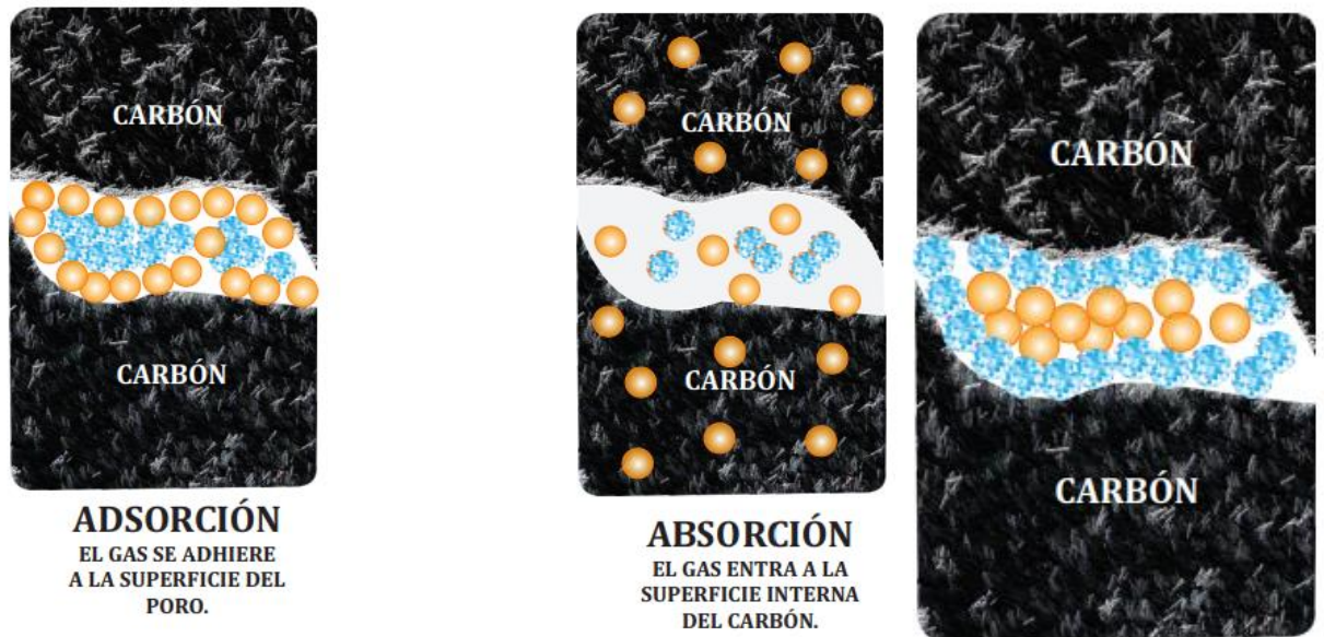
Figura 9. Adsorción, Absorción y Gas libre en las estructuras del carbón
