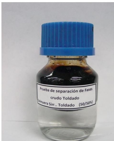
Figura 72. Prueba separación de fases crudo Toldado
