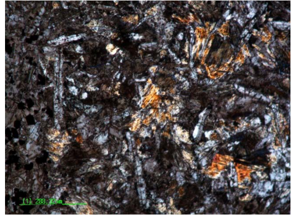
Fig. 15 microfotografía en nicoles paralelos y cruzados en aumento de 5x mostrando plagioclasas, anfíboles y opacos.
