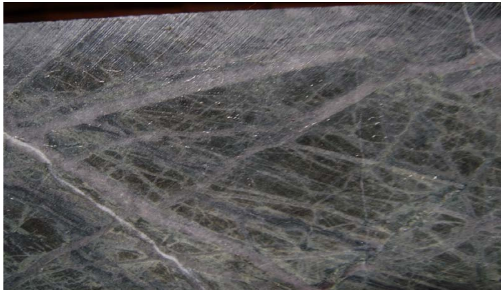
Figura 27: vetillas tipo A con arreglo de stockwork y leves inclusiones de sulfuros.
