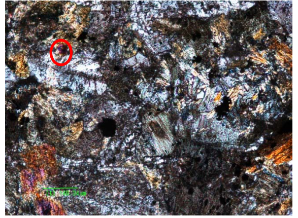
Fig. 18. Microfotografía en nicoles paralelos y cruzados en aumento de 5x mostrando la textura subofítica.
