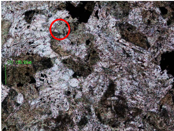
Fig. 15 microfotografía en nicoles paralelos y cruzados en aumento de 5x mostrando plagioclasas, anfíboles y opacos.
