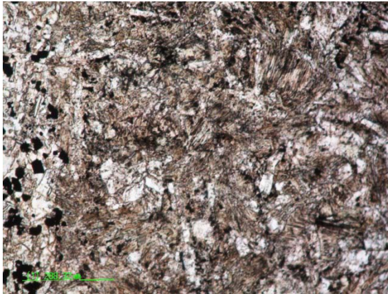
Fig. 15 microfotografía en nicoles paralelos y cruzados en aumento de 5x mostrando plagioclasas, anfíboles y opacos.
