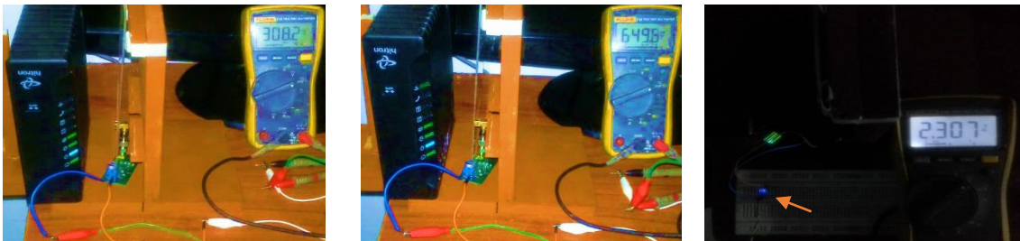
Fig. 44, Prueba de campo captando la energía RF de un router de WIFI y convirtiéndola en corriente eléctrica en DC para encender un LED de color azul
