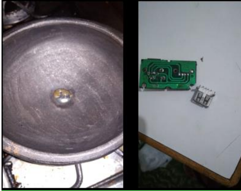
Figura 8. Proceso de desensamble con piscina de estaño.
