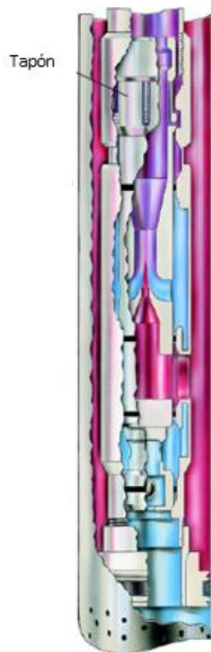
Figura 8. Bomba Jet de Circulación Inversa
