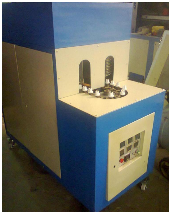
Figura 8. Horno calentador de preformas.
