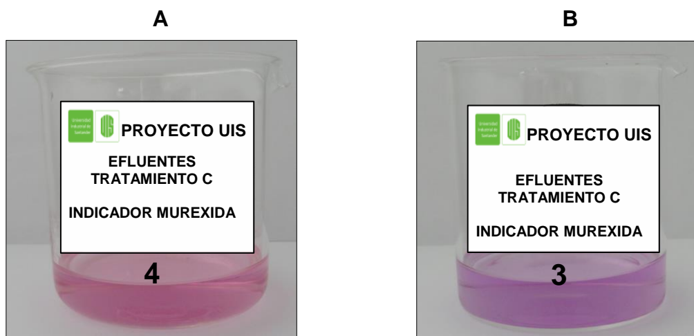
Figura 29. Valoración complexométrica con indicador murexida a los efluentes de la prueba de desplazamiento. A) Volumen poroso N°4 indicando ausencia del tratamiento C. B) Volumen poroso N°3, presencia del tratamiento C.
