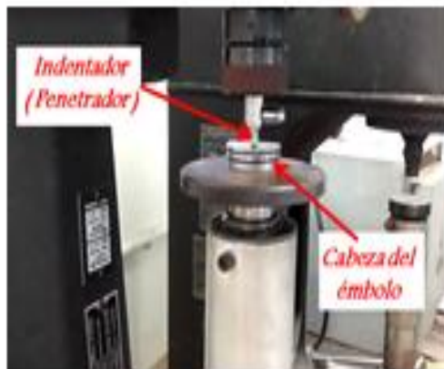
c.) Indentador aplicando fuerza a la muestra del émbolo
