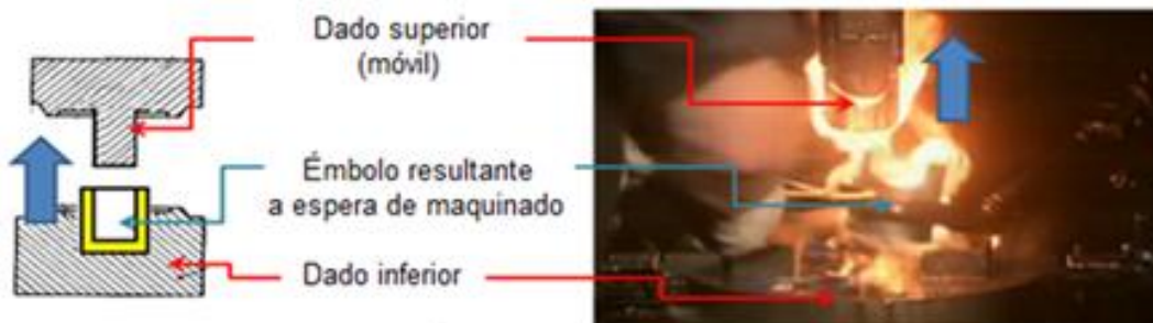
c.) Émbolo obtenido por forjado
