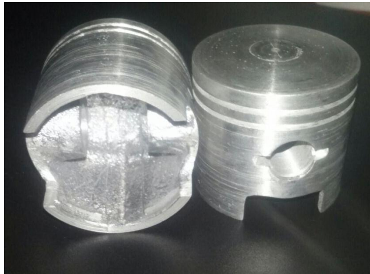
Figura 64. Émbolo prototipo resultante
