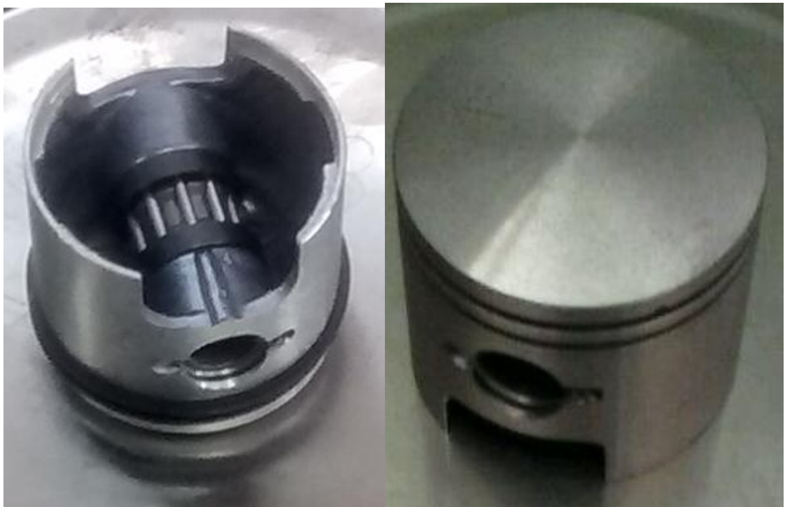
Figura 3. Émbolo motor Shindaiwa S450EC1
