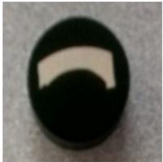
Segmento del émbolo por corte transversal embebido en la baquelita.
