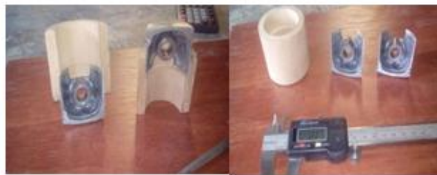
a.) Adecuación preliminar del molde en madera moldear el macho de sacrificio
