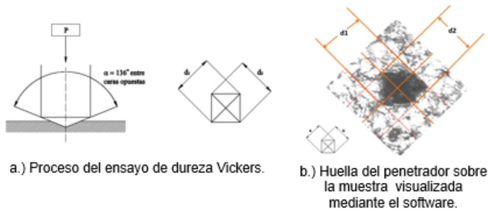
Figura 30. Ensayo de dureza Vickers.
