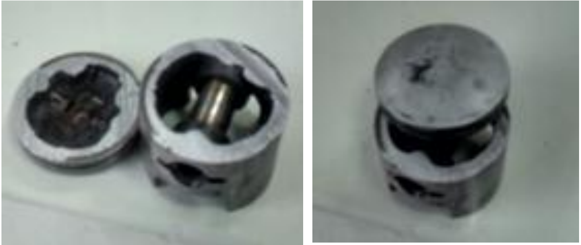
Figura 16. Corte de la cabeza del émbolo
