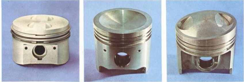
Ilustración 5. Formas particulares de la cabeza del émbolo de algunos motores.
