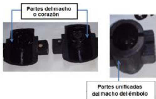
b.) Molde en madera con pintura refractaria para el moldeo del macho Para observar las dimensiones del molde, el proceso en detalle y el macho resultante véase el anexo M.
