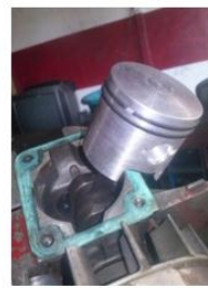
b.) Cambio por el émbolo prototipo conectado a la biela en el motor
