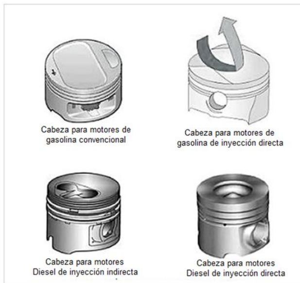
Ilustración 4. Formas de cabezas típicas del émbolo.
