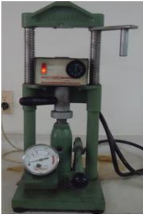
Baqelita sometida a la prensa de compresión.
