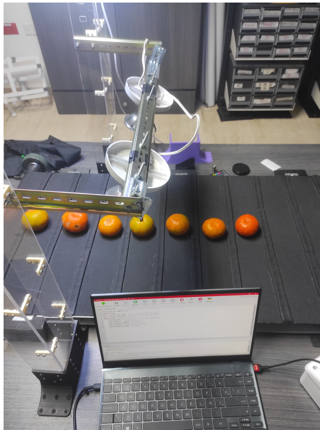
Figura 5. Banda transportadora utilizada para la toma de imágenes de mandarinas
