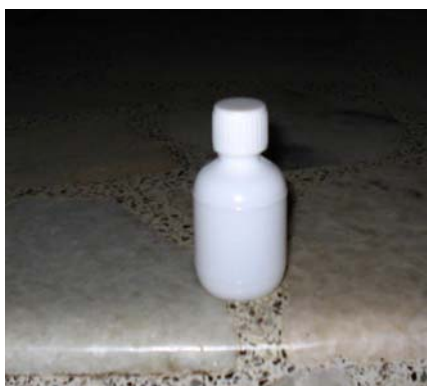
Foto 6. Frasco para el envío de la muestra de precipitación al laboratorio (50 ml) 14
