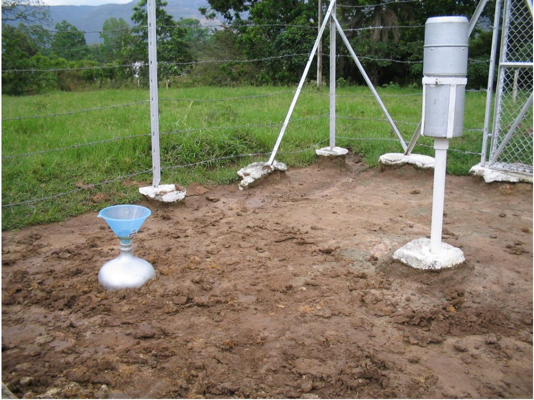
Foto 11. Depósito colector enterrado
