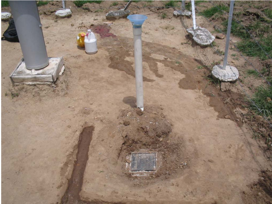
Foto 15. Muestreador alto riesgo de evaporación, sin presencia de nivel freático
