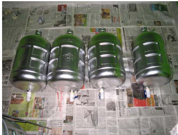
Foto 7. Depósitos colectores con pintura reflexiva a base de aluminio
