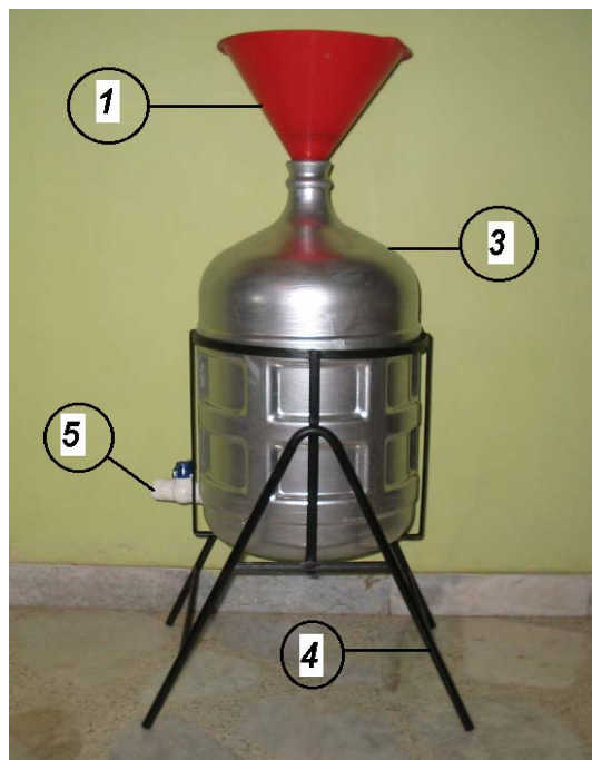
Foto 2. Depósito colector de agua lluvia
