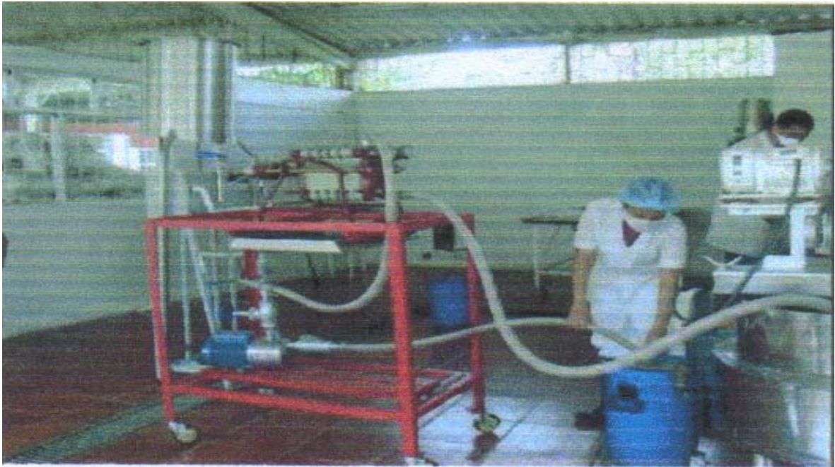
Foto 6. Filtración a través de un filtro prensa.
