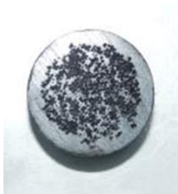
Figura 36. Huellas del propante impresas en la muestra de roca posterior al ensayo triaxial
