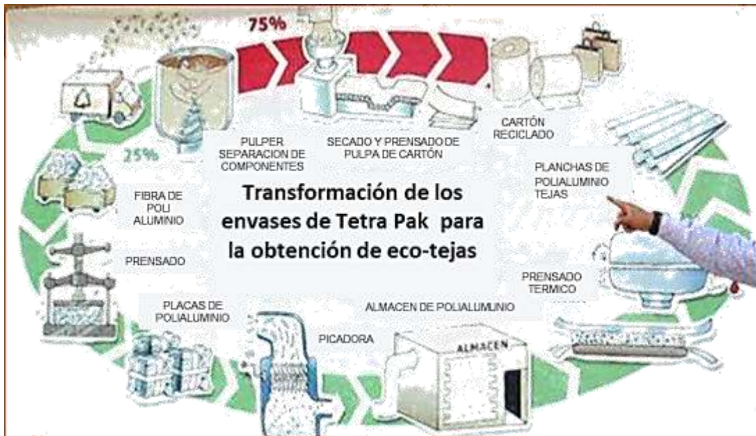
Imagen 7. Proceso de transformación para la obtención de eco-tejas.
