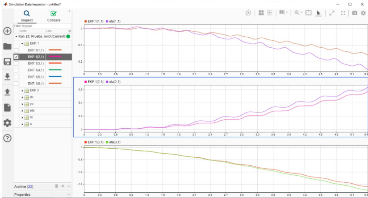
Figura 30. Resultados gráficos de los estados del modelo y el filtro de Kalman extendido con periodo de muestreo de 0.01
