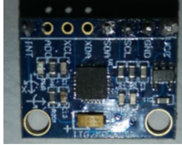
Figura 10. Sensor inercial que incluido en el ROV
