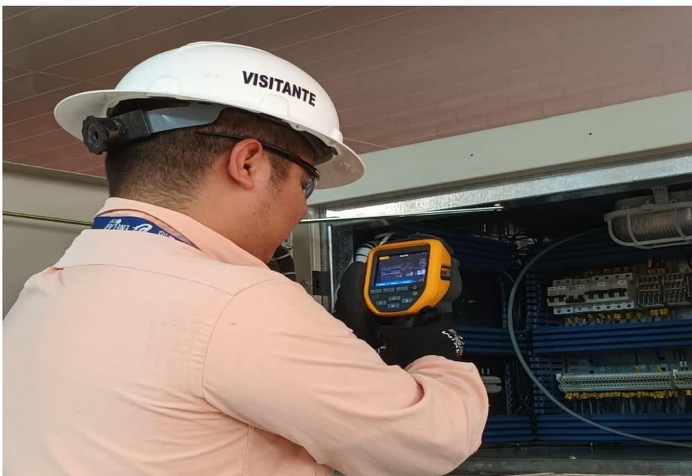
*Imagen 43. Inspección termográfica en nivel de tensión I en S/E Tame – Fuente: Autor.*
