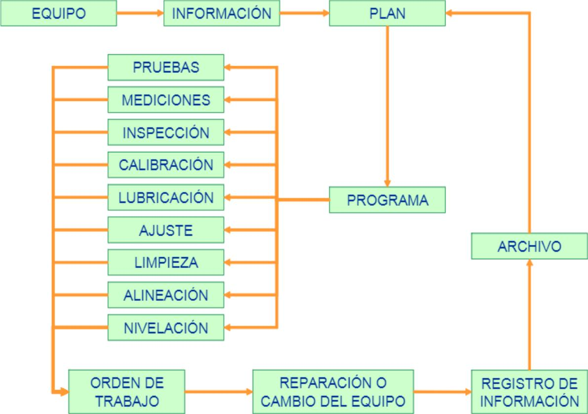
Imagen 9. Flujo de trabajo en el mantenimiento preventivo – Fuente: Javier Mauricio Gómez Nieto “SOFTWARE TUTORIAL DE TERMOGRAFÍA APLICADA A LA INGENIERÍA DE MANTENIMIENTO” Monografía UIS.
