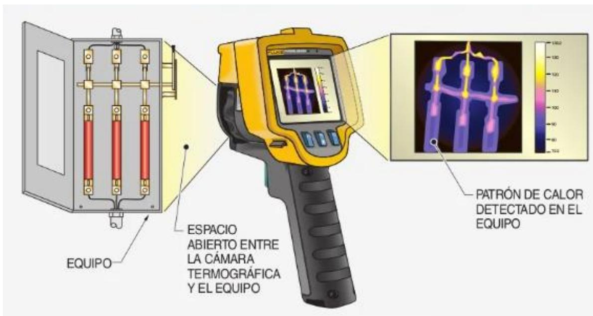
Imagen 28. Cámara termográfica – Fuente: Fluke “Introducción a los principios de la termografía”, <https://www.fluke.com/es-co/producto/accesorios/otros/fluke-book-itp>
