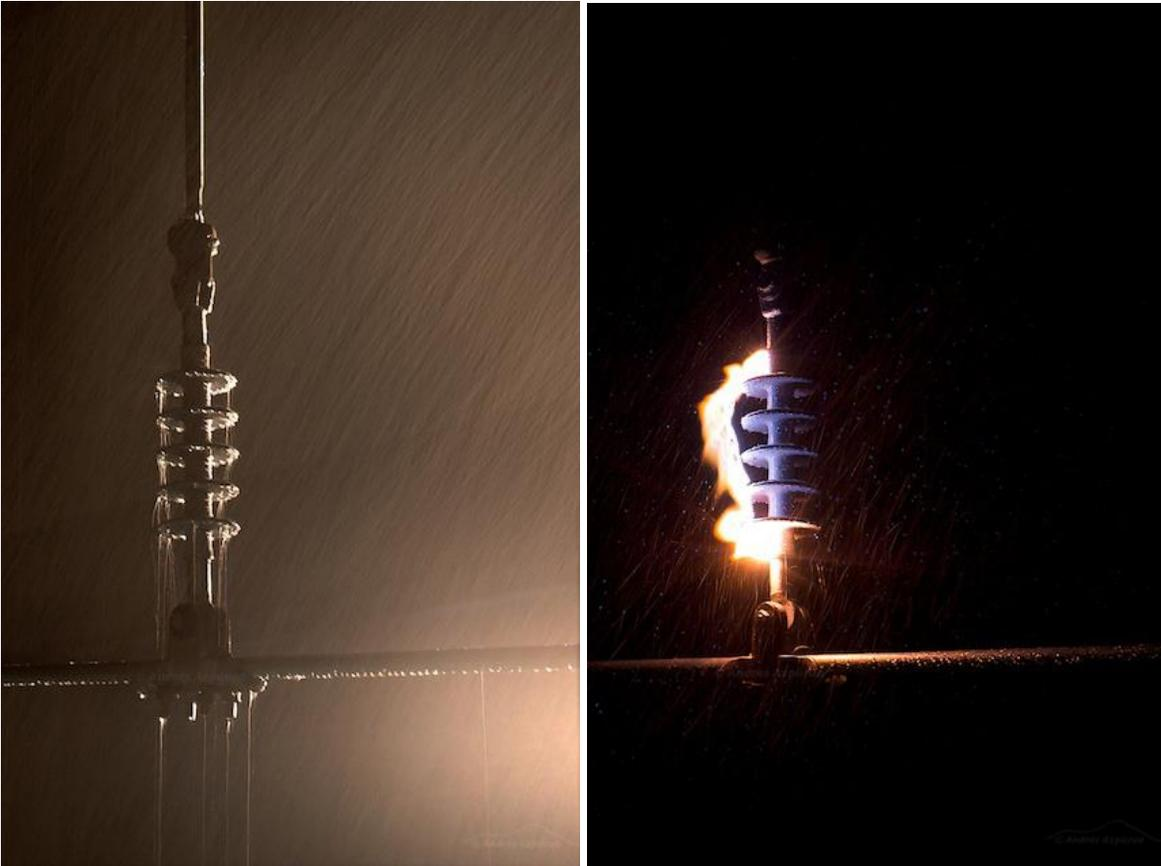
*Imagen 16. Arco eléctrico producido bajo la lluvia en aislador cerámico – Fuente: A. Andrés, prueba en alta tensión de la Universidad simón Bolívar, Venezuela.*
