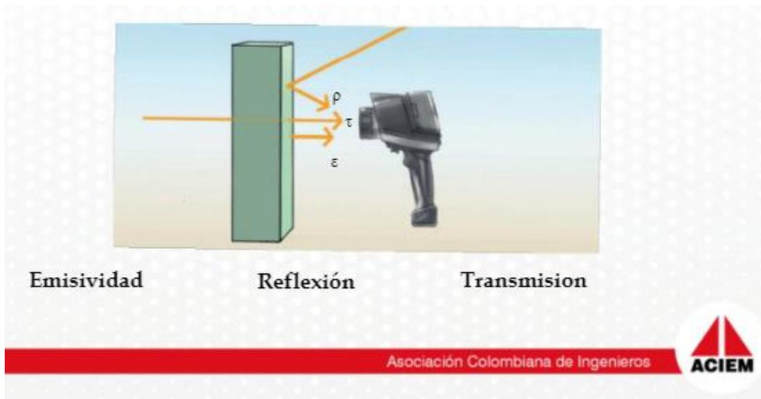
Imagen 6. Componentes de la radiación registrados por cámara termográfica provenientes de objetos presentes en el campo de visión de la cámara – Fuente: ACIEM “Termografía básica”, [https://issuu.com/memorias\\_conferencias\\_aciem/docs/memorias\\_conf\\_13\\_jul\\_2020\\_pm](https://issuu.com/memorias_conferencias_aciem/docs/memorias_conf_13_jul_2020_pm).
