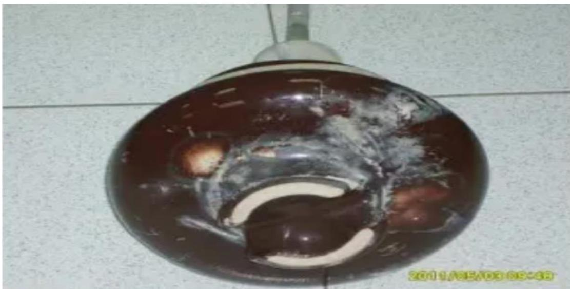
*Imagen 19. Aislador de porcelana afectado por tracking eléctrico – Fuente: Mario Ricardo Cárdenas Barrero, Miguel Eugenio Garzón artículo “DIAGNÓSTICO DE REDES DE DISTRIBUCIÓN AEREA DE 11,4 HASTA 34,5 KV CON LA TÉCNICA DE ULTRASONIDO.”*
