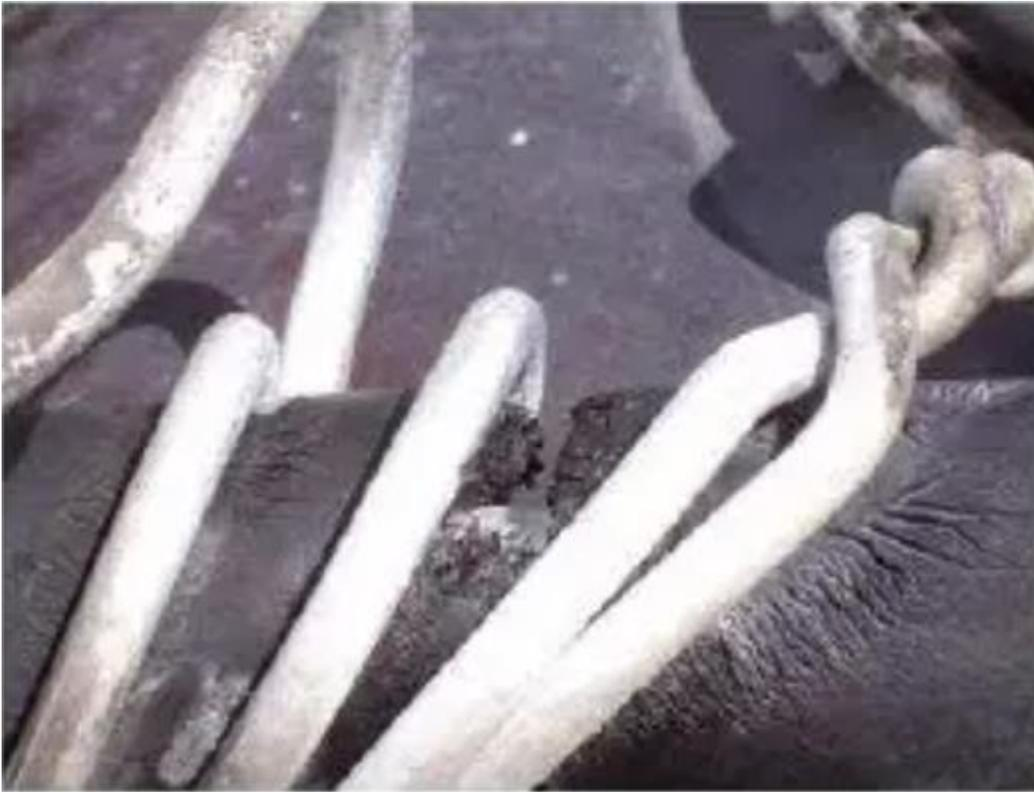
*Imagen 21. Acercamiento al conductor semi-aislado afectado por tracking eléctrico de la imagen 20 – Fuente: Mario Ricardo Cárdenas Barrero, Miguel Eugenio Garzón artículo “DIAGNÓSTICO DE REDES DE DISTRIBUCIÓN AÉREAS DE 11,4 HASTA 34,5 kV CON LA TÉCNICA DE ULTRASONIDO.”*
