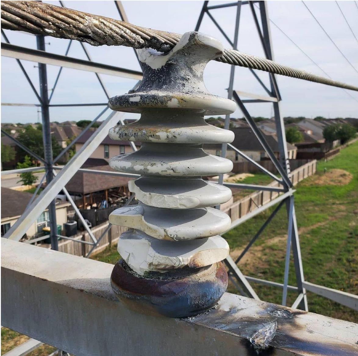
*Imagen 17. Aislador de porcelana deteriorado por arco eléctrico – Fuente: Alfonso Merla curso tesla “Cinco métodos para evitar el arco eléctrico en aisladores”.*
